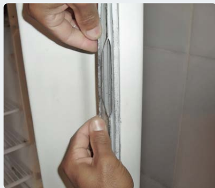
Borracha da porta da geladeira com problemas
